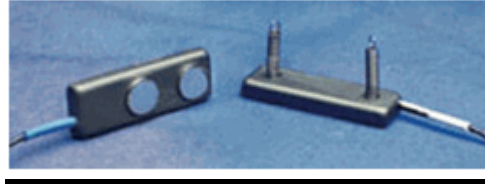
شكل (2.3) أقطاب سطحية فعالة (تحتوي على الجل بداخلها) لتسجيل إشارة ECG
