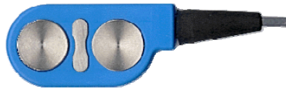
شكل (5.3) أقطاب سطحية لتسجيل إشارة EMG
