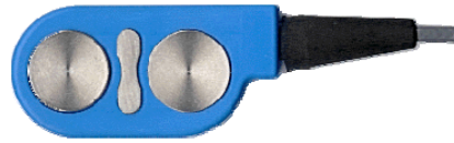
شكل (2.1) أقطاب سطحية لتسجيل إشارة EMG
